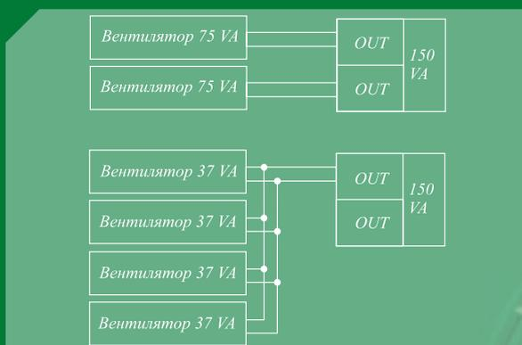
Вентиляторы подключаются к выходам "OUT" силовых блоков. Суммарная мощность подсоединенных вентиляторов не должна превышать мощности силового блока. Пример подключения вентиляторов к силовому блоку мощностью 300 В А.
