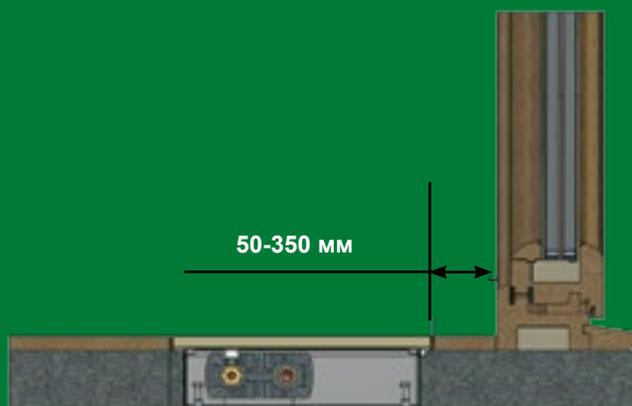
2.4 При выборе места установки удостоверьтесь в возможности подведения к конвектору тепловой магистрали, электрики (для приборов с принудительной конвекцией) и магистрали по отводу конденсата (для дренажных приборов).
