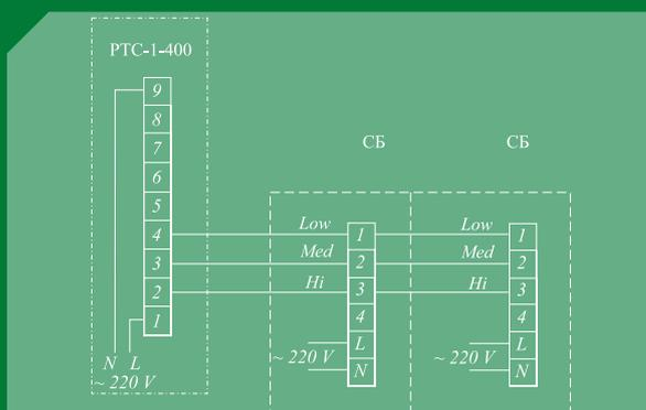
Подключение терморегулятора РТС-1-400 к блоку СБ100-3, СБ150-3, СБ 300-3 (трехскоростной режим)
