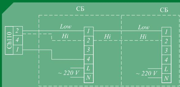
Подключение цифрового терморегулятора СН 110 к блоку СБ100-2, СБ150-2, СБ 300-2
