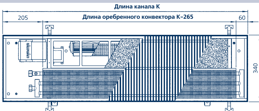
Разрез: прибор высотой 112 мм с прямой решеткой
