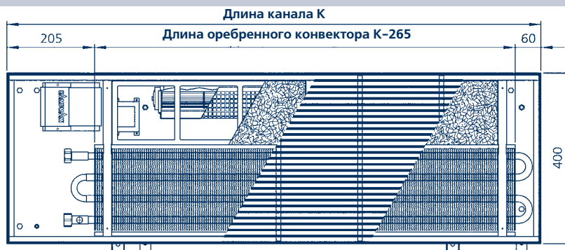
Разрез: прибор высотой 112 мм с рулонной решеткой
