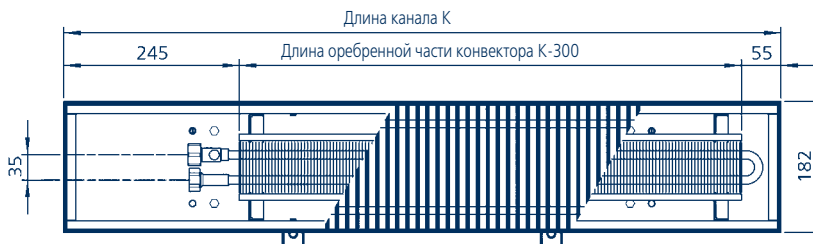
Вид сверху. Пример монтажа с роллонной решеткой.
